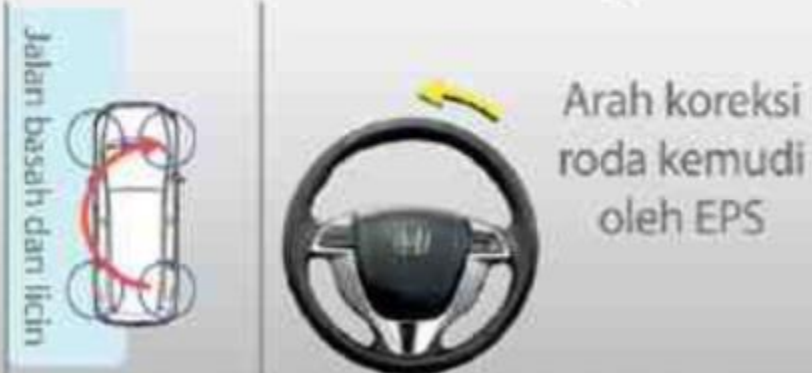
Gejala Slip pada permukaan jalan berbeda (Basah dan Kering)
